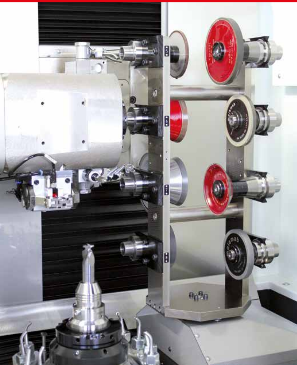
A szeriaszerűen az S22-be beépített 8-állású köszörűszerszám cserélő
