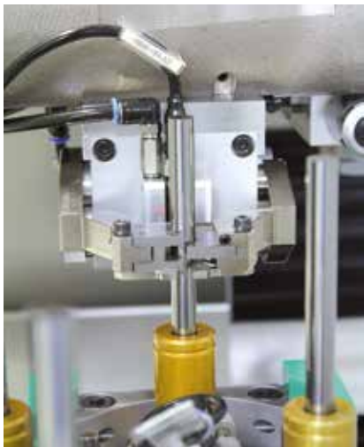
A nyers darab kiemelése a láncos adagolóból
